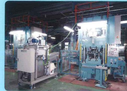
冷間鍛造で作られたヨークは、ファイバーフロー（組織の流れ）効果により、剛性と靱性（しなやかさ）に優れています。
