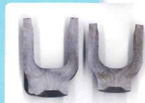
冷間鍛造で作られたヨークは、ファイバーフロー（組織の流れ）効果により、剛性と靱性（しなやかさ）に優れています。
